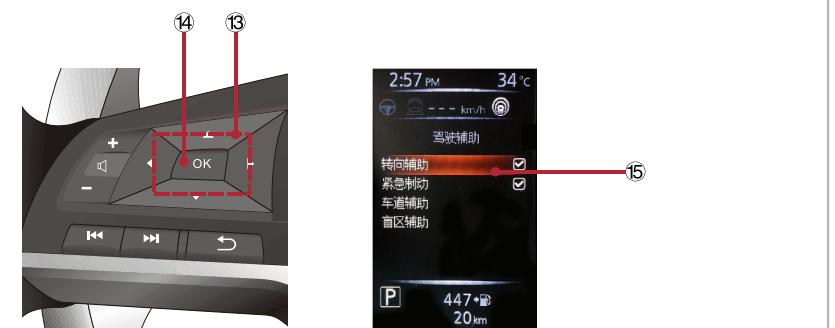
■ 要使用车辆信息显示关闭转向助手：
