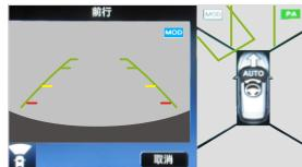
MOD系统在车辆停止或车速低于8km/h时工作，该系统可在驾驶出车库、驶入停车位以及在其他类似场合中提醒驾驶员移动的物体。
