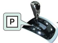
将换挡杆置于档 P 位置 + 按压发动机启动开关。
