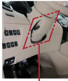
推动方向盘调节杆至位置①，上下前后调节方向盘至合适的位置后，拉动方向盘调节杆至位置②以锁止方向盘位置。
