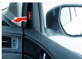
BSW系统在车速超过32km/h时工作，有助于在变换车道时警示驾驶员相邻车道上有其他车辆。
