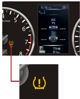
轮胎压力低警告灯能够实时监测TPMS故障，当系统工作不正常时该灯会闪烁1分钟后持续点亮，此时系统可能无法监测轮胎压力，在更换轮胎或轮胎换位时，可能引起TPMS故障。
