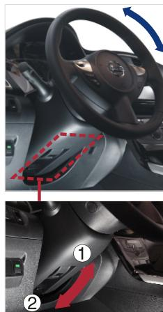
拉动方向盘调节杆至位置①，上下调节方向盘至合适的位置后，推动方向盘调节杆至位置②以锁止方向盘位置。
