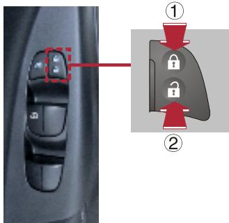
按下开关前端①/后端②将锁止/解锁所有车门。
