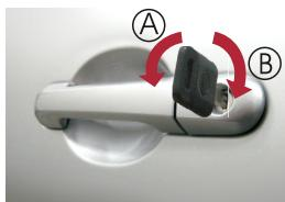
Ⓐ 向车头方向旋转钥匙将锁止驾驶侧车门。
