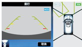
MOD系统在车辆停止或车速低于8km/h时工作，该系统可在驾驶出车库、驶入停车位以及在其他类似场合中通知驾驶员移动的物体。
