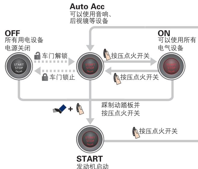
为避免电池过度耗电，如下状态在发动机没有启动情况下进行自动切换：
