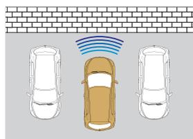
EAPM系统在车速低于约15km/h时工作。当在进行停车入位的区域存在障碍物时，此系统有助防止碰撞或减少损失。
