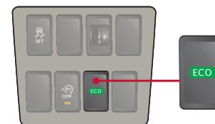
通过按压ECO开关来开启ECO经济驾驶模式；要关闭ECO模式，请再次按压ECO开关。
