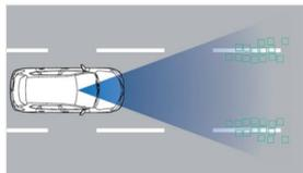
LDW系统在车速超过70km/h时工作，此系统有助于在车辆行驶靠近车道的左侧或右侧时警示驾驶员。
