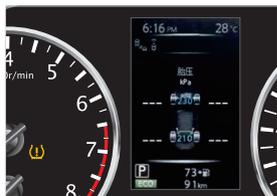
轮胎压力低警告灯同时能够监测TPMS故障，当系统工作不正常时该灯会闪烁1分钟后持续点亮，此时系统可能无法监测轮胎压力，在更换轮胎或轮胎换位时，都可能引起TPMS故障。
