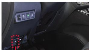
拉动开关，燃油加注口罩将自动弹开
