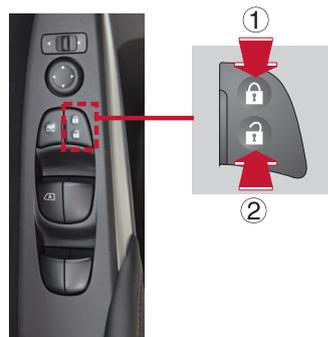
按下开关前端①/后端②将锁止/解锁所有车门。
