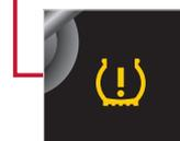
轮胎压力低警告灯同时能够监测TPMS故障，当系统工作不正常时该灯会闪烁1分钟后持续点亮，此时系统可能无法监测轮胎压力，在更换轮胎或轮胎换位时，都可能引起TPMS故障。
