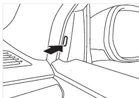
当检测到盲区区域有车辆时，如转向信号激活，系统将鸣响两次，且盲区指示灯闪烁以提醒驾驶员。
