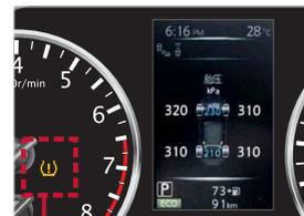
当一个或多个轮胎压力明显低时，轮胎压力低警告灯将点亮，此时应尽快检查轮胎，然后充气至正常压力。
