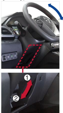
拉动方向盘调节杆至位置①，上下调节方向盘至合适的位置后，推动方向盘调节杆至位置②以锁定方向盘位置。
