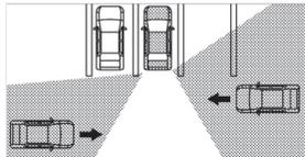
此系统有助于在倒车时警示后方移动的物体。当换挡杆处于倒车档且车速小于8km/h，此系统可监控后方约20m以内移动的物体，并发出音/视频警报。
