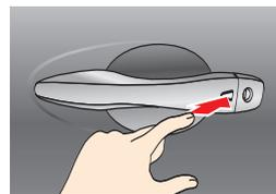
随身携带智能钥匙，通过按压车门上的请求开关，可以实现车门的锁止和解锁。
