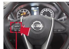
按下 开关，可依次切换显示界面；上下拨动 开关，可上下选择不同的项目；按下 开关，可进入相应界面；按下 开关，可返回上一级界面。
