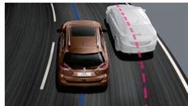
通过感应方向盘、油门与刹车操作，及时判断车辆过弯制动需求，自动调整发动机机制动水平，协助驾驶者把车速控制到理想的入弯速度，减少主动刹车频率，提供制动效率。
