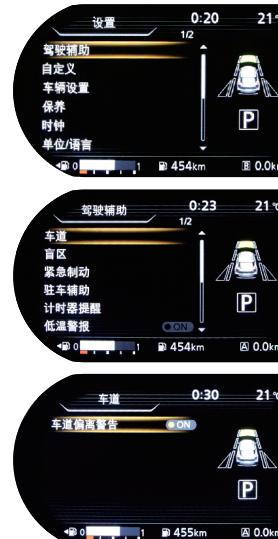
使用[◀]开关，直到切换进去设置界面。按下[OK]，进入“驾驶辅助”界面。通过选择不同系统并同时按下[OK]开关来开启/关闭各系统。
