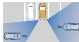
此系统有助于在倒车时警示后方横向移动的物体。当换挡杆处于倒车档且车速0-15km/h，此系统可监控后方约20m以内移动的物体，并发出音/视频警报。
