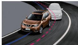
通过感应驾驶员刹车、加速及方向盘转向动作，判断弯道轨迹，通过对车轮的主动制动，令车辆不会偏离弯道轨迹，有效提升过弯性能。
