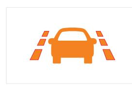
LDW系统在车速超过70km/h时工作，此系统有助于在车辆行驶靠近行车道的左侧或右侧时警示驾驶员。
