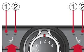
按下加热座椅开关，每按一次温度模式按照高-低-关闭循环。
