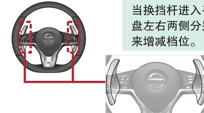
当换挡杆进入手动换档模式，可以通过拨动方向盘左右两侧分别带“+”号“-”号的换挡拨片来增减档位。
