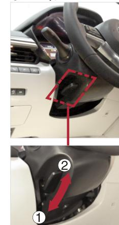
推动方向盘调节杆至位置①，上下前后调节方向盘至合适的位置②后，拉动方向盘调节杆至位置以锁止方向盘位置。
