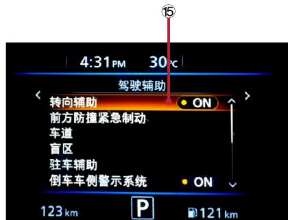
■ 要使用车辆信息显示关闭转向助手：
