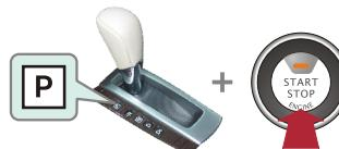
将换挡杆置于档 P 位置 + 按压发动机启动开关。
