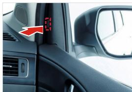
BSW系统是在车速超过32km/h时工作，有助于在变换车道时警示驾驶员相邻车道上有其他车辆。
