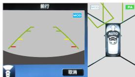
MOD系统在车辆停止或车速低于8km/h时工作，该系统可在驾驶出车库、驶入停车位以及其他类似场合中提醒驾驶员移动的物体。
